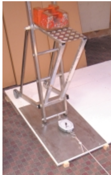
LSD actual Base/Top Contact Test
